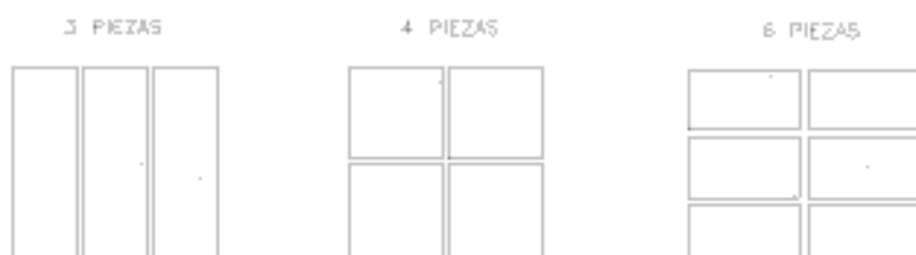
CASETONES ALIGERANTES HABITUALES FORMADOS CON DIVERSOS TIPOS DE BLOQUES DE HORMIGÓN
